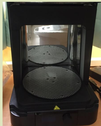
右圖：3D列印機，(右上) 3D列印機，(右下) 光照機 (用途：利用光照來硬化3D列印後的樹脂材料)
